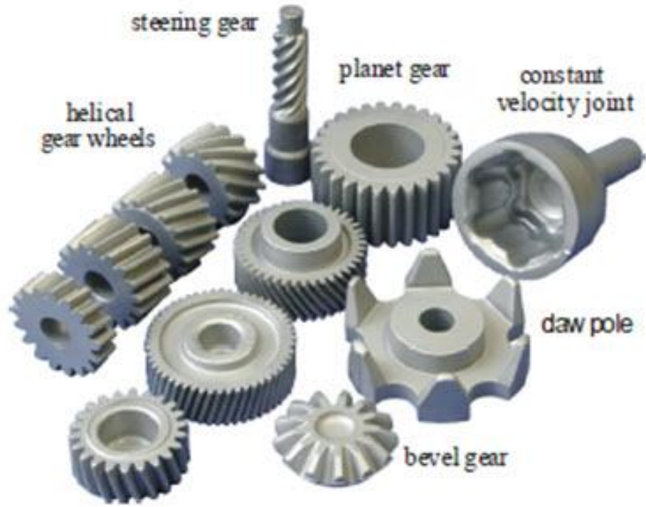
تروس وأجزاء ميكانيكية مصنعة بواسطة الحدادة بلا ومض
