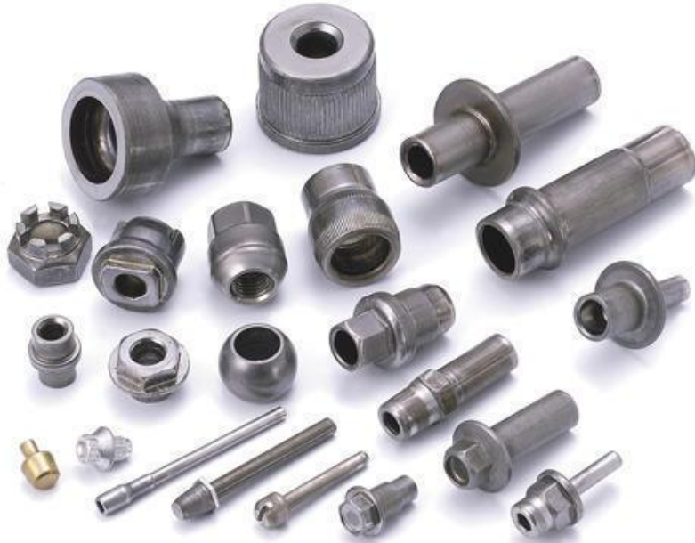
أجزاء ميكانيكية متنوعة مصنعة بواسطة الحداة بلا ومض
